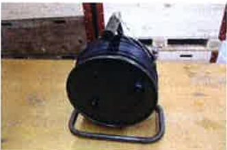
Kabelrolle Typ I mit 60m Kabel RG213/U
